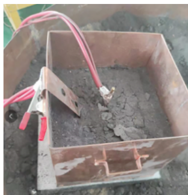
图2 沙土试验样品
