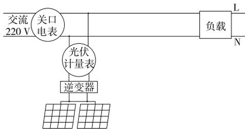
图2 分布式光伏发电简化原理
