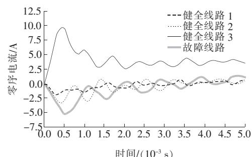
图 3 各出线暂态零序电流
