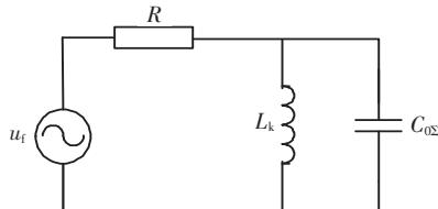
图 2 谐振接地系统单相接地故障点暂态等值电路
