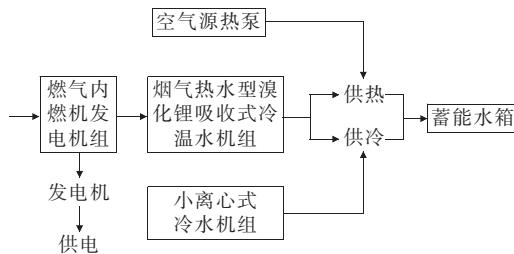
图2 冷热电三联供系统主体结构
