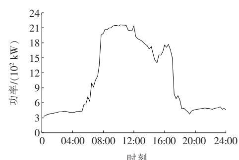
**图 11** 园区离网运行状态下重要负荷的电能需求
