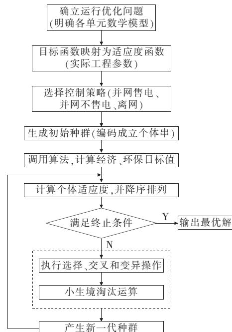
图 4 分布式能源互联网优化调度算法
