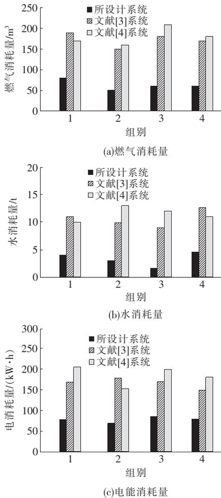
图 3 燃气、水、电能消耗量对比结果
