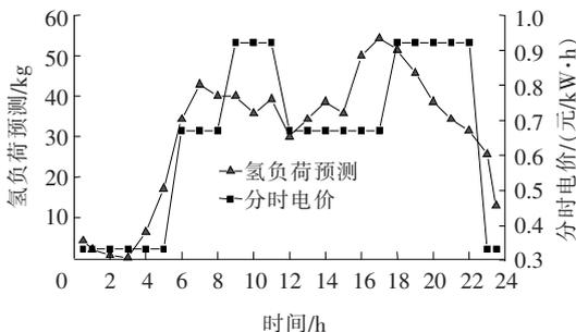
图 5 分时电价与氢燃料电池汽车需求预测曲线
