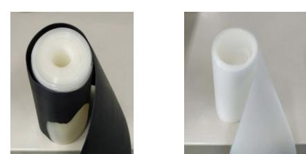
图 1 环切后的电缆试样
