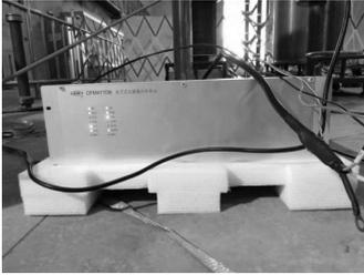
图 9 被测模拟量输入直流合并单元
