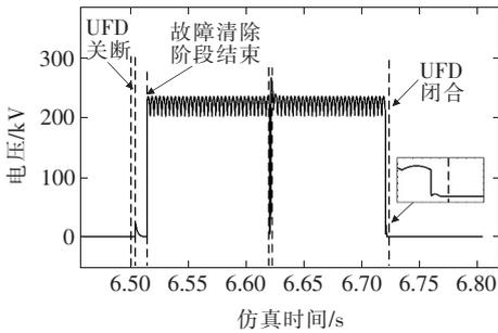
图 13 快速机械开关 UFD 电压波形
