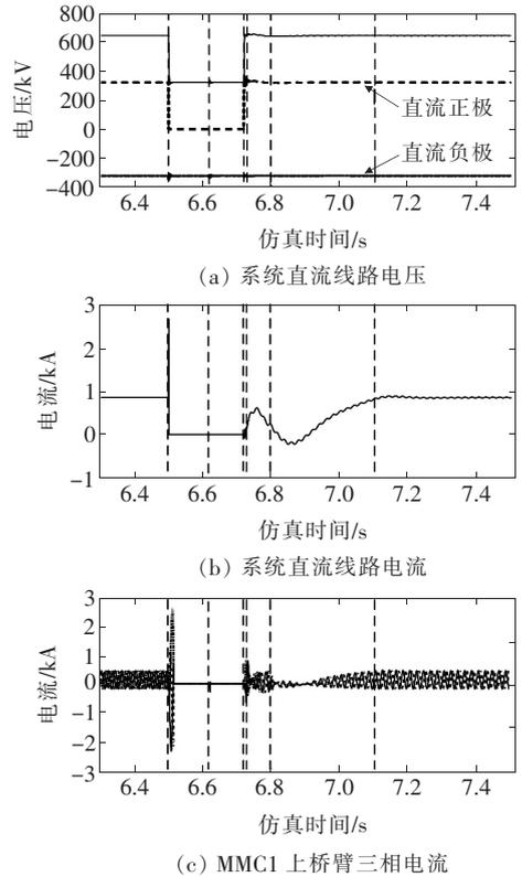
图 14 故障线路重启恢复过程波形
