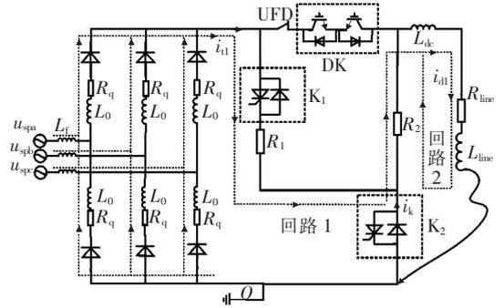
图 7 系统故障清除判定过程等效示意
