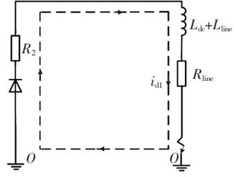
图 5 直流线路短路电流衰减等效示意
