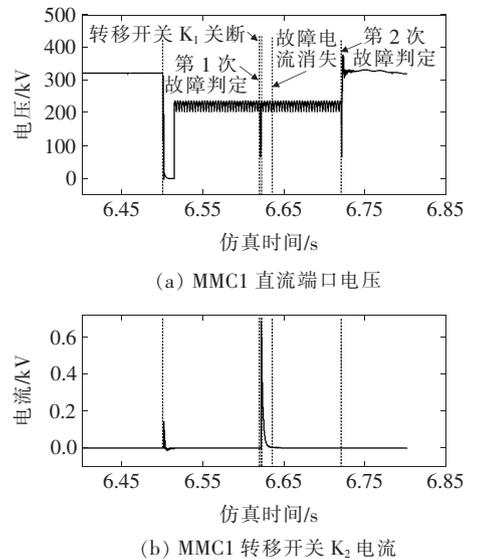
图 12 直流故障清除判定过程仿真波形
