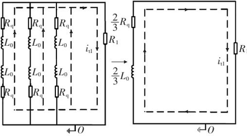
图 4 阀侧短路电流衰减等效示意
