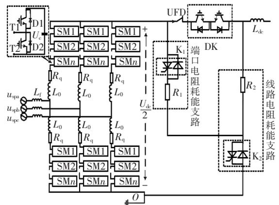
图 1 基于电阻耗能支路的改进 MMC 结构
