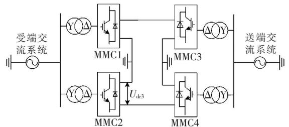
图10 双端双极MMC-HVDC系统模型
