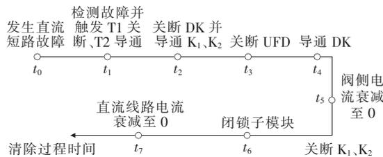
图 3 系统故障清除过程控制时序
