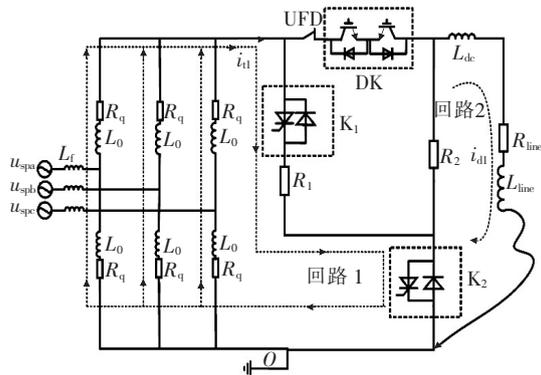
图 2 MMC 直流故障清除过程等效示意
