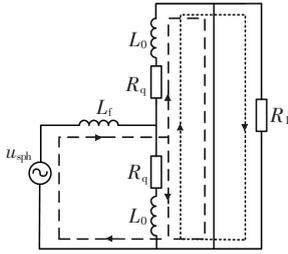
图 6 MMC 的 B 相桥臂电流回路等效示意
