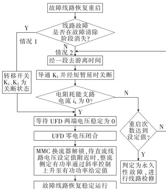
图9 直流故障线路恢复控制策略流程
