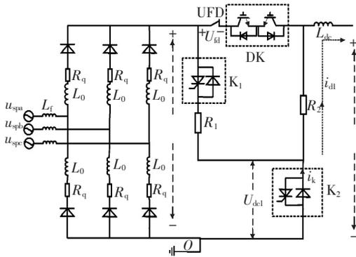
图8 UFD零电压闭合过程等效示意
