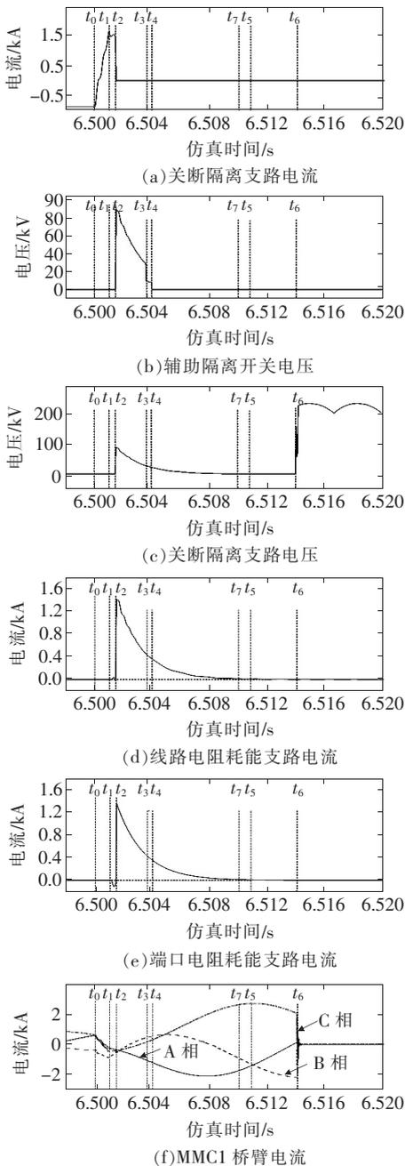
图 11 直流故障清除过程仿真波形
