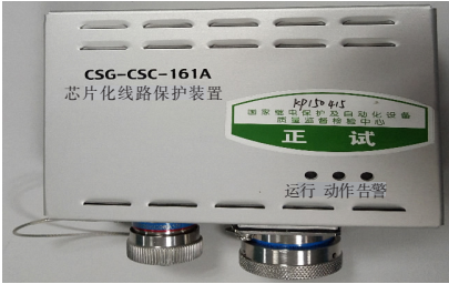
图 8 芯片化线路保护装置 Figure 8 Chip circuit protection
