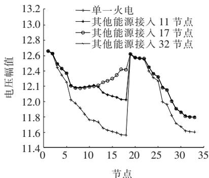
图 4 不同位置分布式能源接入后系统节点电压分布
