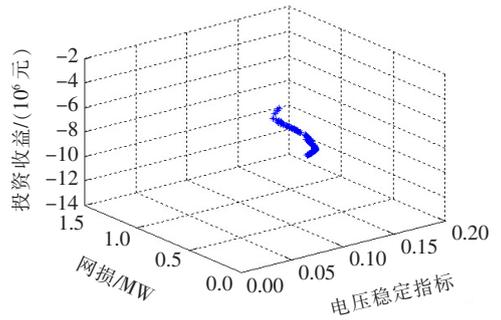
图 14 仅接入微型燃气轮机时的 Pareto 最优解
