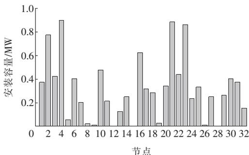
图 10 方案 3 的分布式能源容量配置
