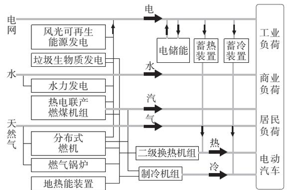
图 1 多能互补系统能源流架构
