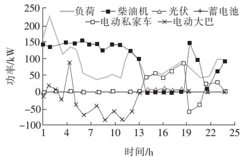
图 5 电动汽车最优组合的微网 24 h 负荷及微源出力曲线(方案 5)
