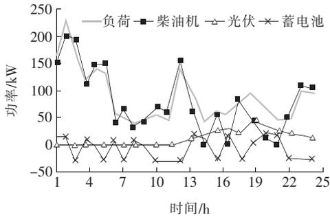
图 1 无电动汽车接入的微网 24 h 负荷及微源出力曲线(方案 1)
