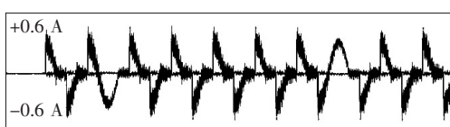
图 9 相地电容 30 \mu\text{F} 配网发生 14.5 \text{ k}\Omega 电阻接地的 镰刀波与锯齿波相间的相地增量电流
