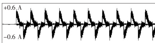
图 8 相地电容 30 \mu\text{F} 配网发生 15 \text{ k}\Omega 电阻接地的 全锯齿波相地增量电流
