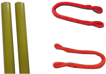
图 2 老化处理前后绝缘杆和绝缘绳
